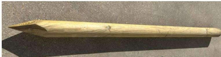
Método de aplicación empleado: Sistema Bethell, autoclave vacío-presión-vacío
